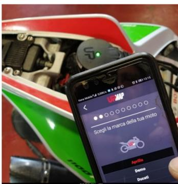
Scaricare la App nel telefono e registrarsi creando il proprio profilo Upmap, poi connettere il T800+ alla presa diagnostica della moto utilizzando il cavo in dotazione. Il cavo 2009-20 "MARELLI", sul connettore nero sotto la sella passeggero e poi al terminale +12v della batteria; il cavo "EURO5a" per le moto 21 va sul connettore quadrato rosso sotto la sella pilota. (foto nella **NOTA C**).
